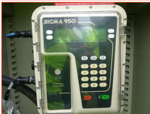
15a eta 15b argazkiak - Lixibiatuak kontrolatzeko emari-neurgailua eta erregistro-sistema
