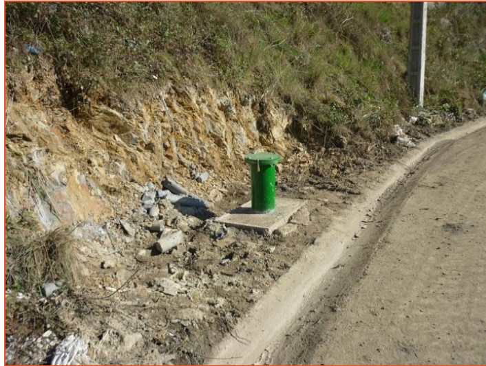
9. argazkia - Zabortege baten kanpoaldeko kontrol-putzua, lurzoruko maila freatikoa neurtu ahal izateko eta lurpeko uraren laginak hartu ahal izateko.
